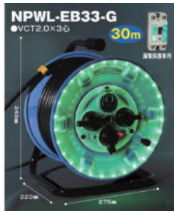
屋外型 NPWL-EB33-G 30m VCT2.0 × 3 芯 15A (全巻時 5A)
