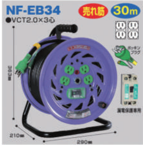
屋内型 NF-EB34 30m VCT2.0 × 3 芯 15A (全巻時 5A)
